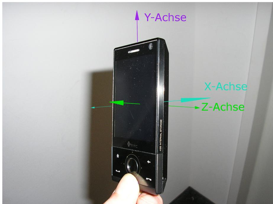
Abbildung 2.3.: Achsen der Beschleunigungssensor des HTC Touch Diamond
