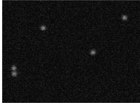
2. Positionsbestimmung der Marker im Bild: Hierzu muss ein performanter Algorithmus die Leuchtdioden im Frame finden und mittels einer Schwerpunktberechnung subpixelgenaue Koordinaten jedes Markers in bildeigenen Koordinaten zurückliefern.
